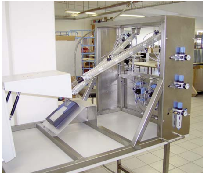
4921射频屏蔽盒在进行机械寿命测试
