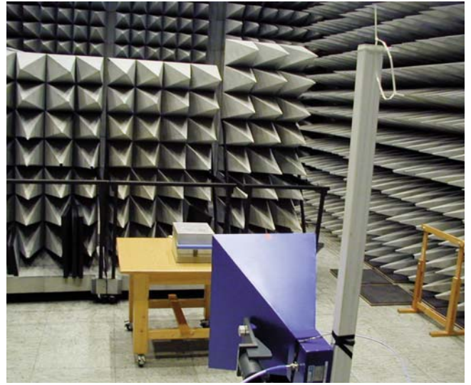
在EMC电磁兼容实验室中, 4921射频屏蔽盒与发射天线
